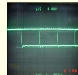
สัญญาณ EFM ขาที่ 66 ของ IC CXD3068Q
