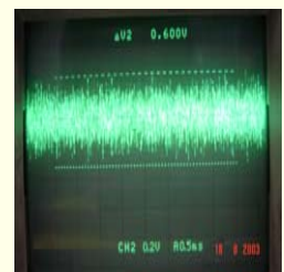
สัญญาณ TE ขาที่ 11 ของ IC CXA2550N
